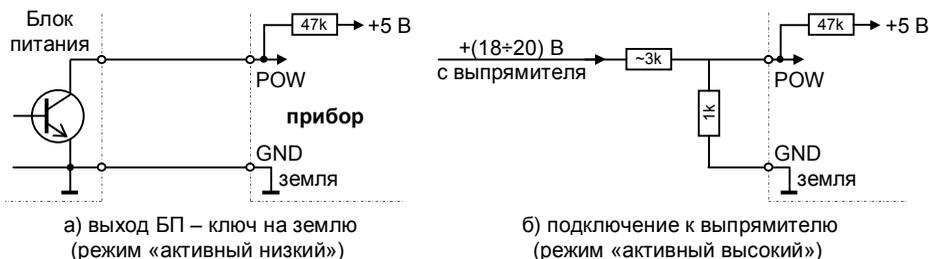
Рис. 5. Примеры монтажа входа POW (контроль сети 220 В)
