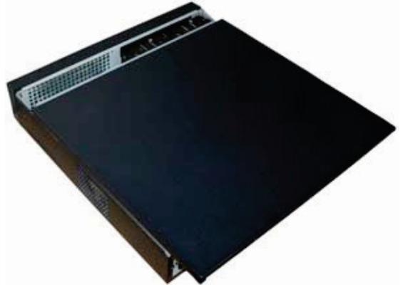
Закрепите HDD к основанию регистратора и в соответствующие полки при помощи винтов через соответствующие отверстия, подключите SATA кабель и кабель питания.
