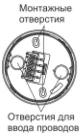
**3** Установить электронный блок извещателя в закрепленную базу:
