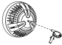
**6** Перед запуском извещателя в эксплуатацию защитную крышку снять!
