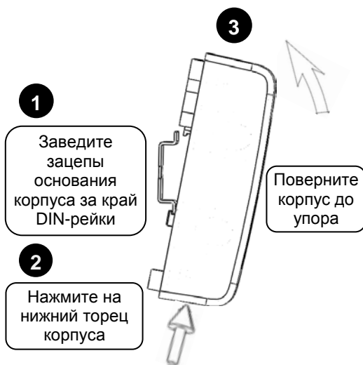
Рисунок 3. Крепление контроллера на DIN-рейку
