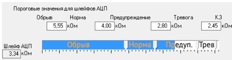
Рисунок 11. Шкала порогов пожарного шлейфа при сработке 1 датчика
