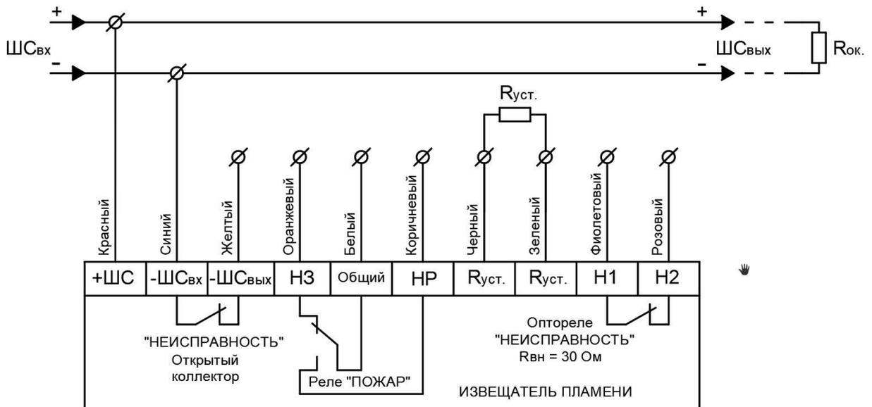
Рисунок 7 – 2-х проводная схема подключения Спектрон-204, -205 без использования режима «НЕИСПРАВНОСТЬ»
