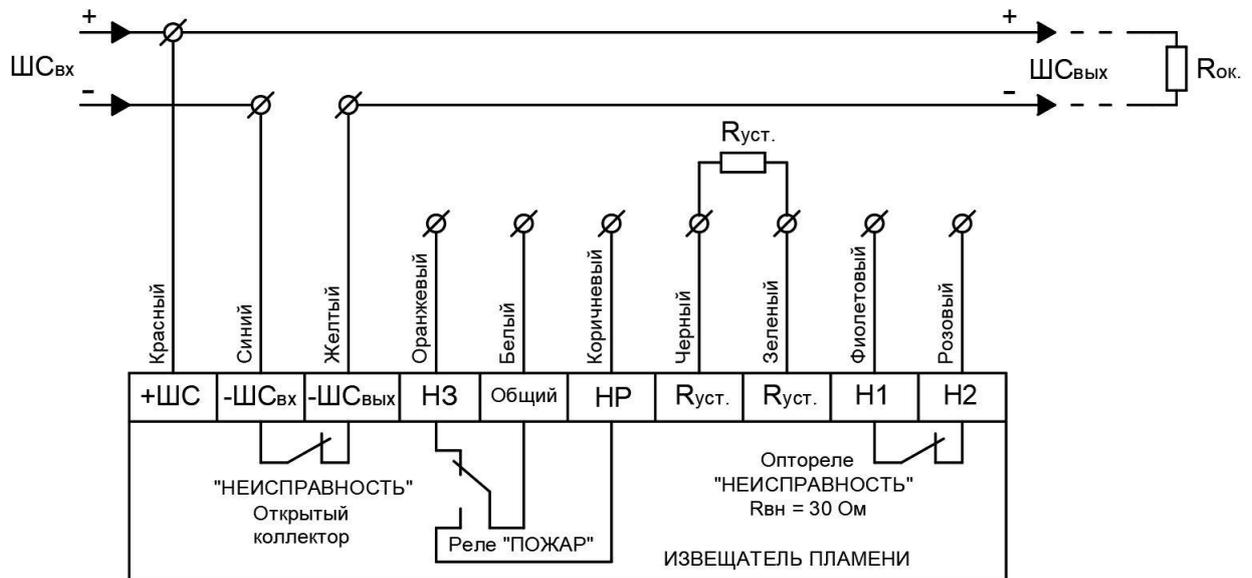
Рисунок 6 – 2-х проводная схема подключения Спектрон-204, -205 с использованием режима «НЕИСПРАВНОСТЬ»
