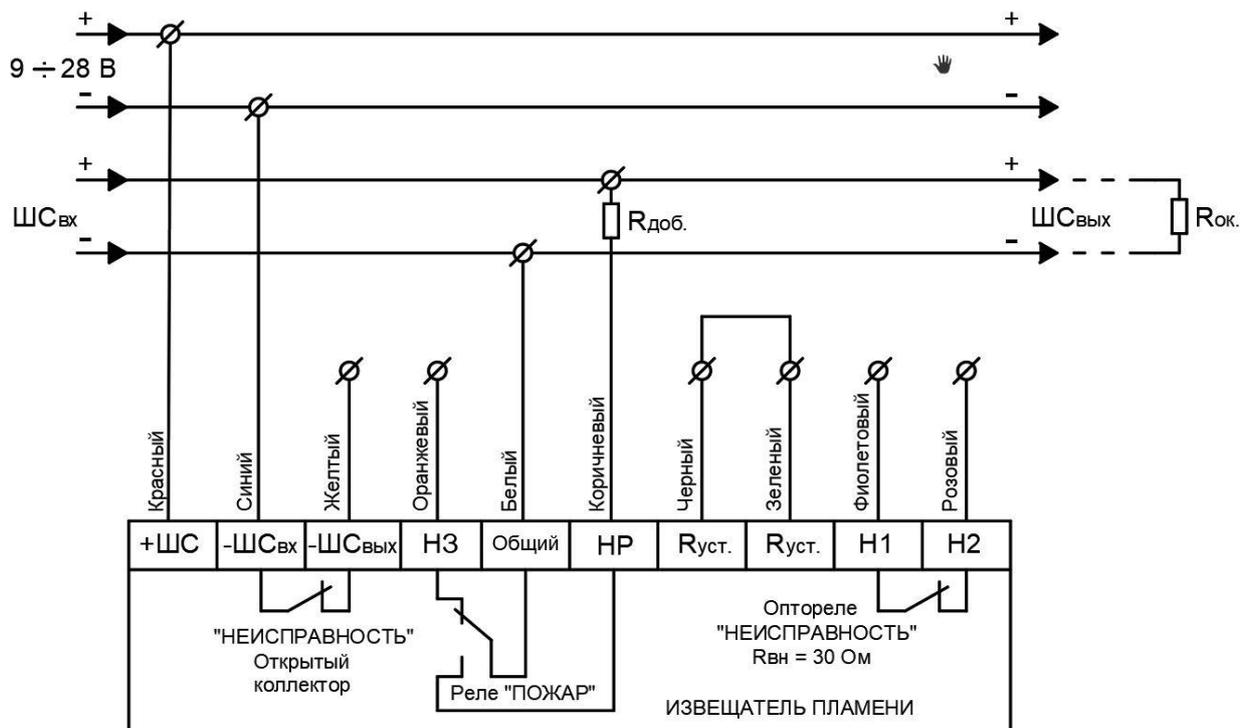
Рисунок 9 – 4-х проводная схема подключения Спектрон-204, -205 без использования режима «НЕИСПРАВНОСТЬ»
