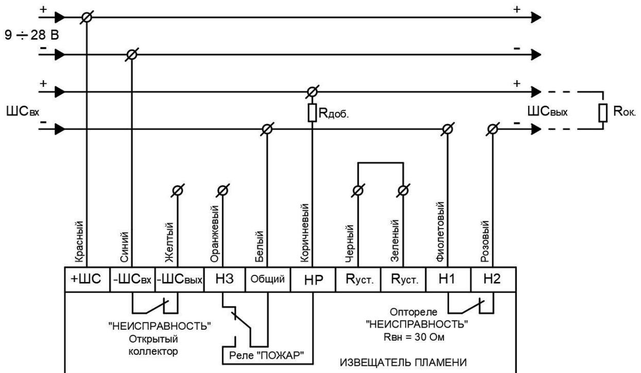
Рисунок 8 – 4-х проводная схема подключения Спектрон-204, -205 с использованием режима «НЕИСПРАВНОСТЬ»
