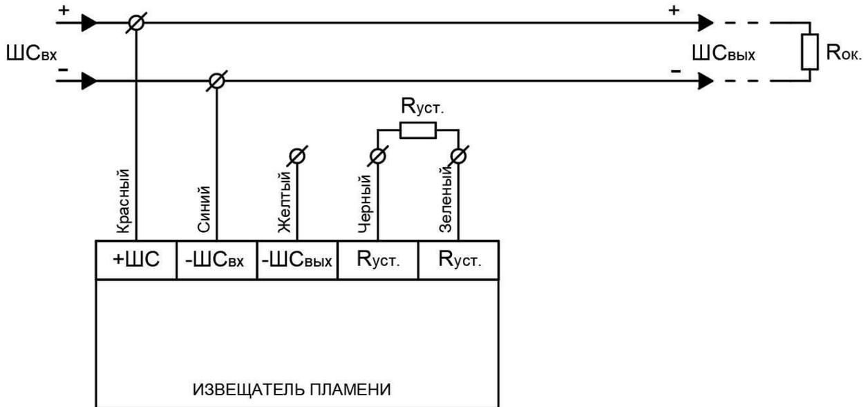
Рисунок 5 – 2-х проводная схема подключения Спектрон-201
