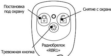
1. Постановка под охрану — нажатие кнопки на брелоке, прикладывание ключа TM к считывателю
