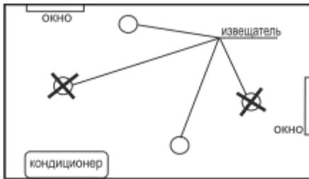
**10.1.3** Площадь, контролируемую одним извещателем, максимальное расстояние между извещателями, извещателем и стеной необходимо определять по таблице 3.
