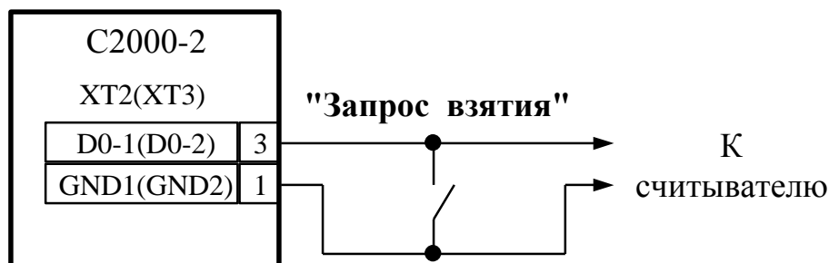
Рисунок 7 Подключение кнопки "Запрос взятия"
