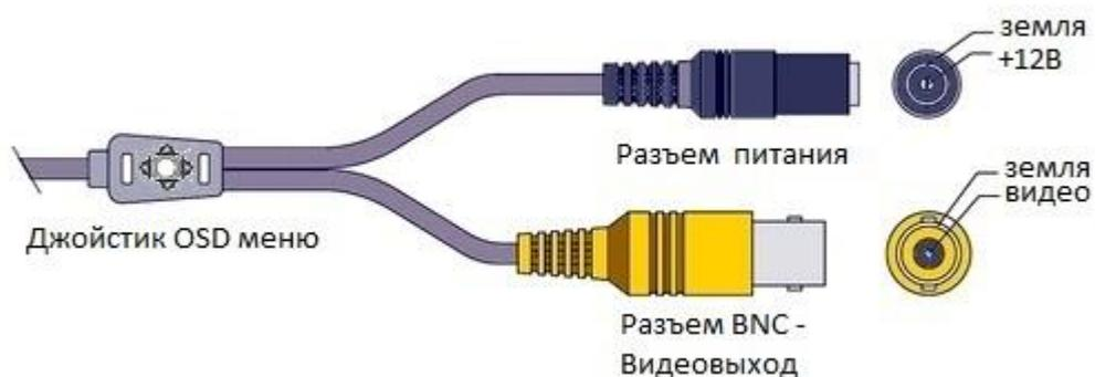
Джойстик OSD меню предназначен для управления переключением режимов работы видеокамеры: АHD/TVI/CVI/CVBS. А также для более детальной настройки видеокамеры.
