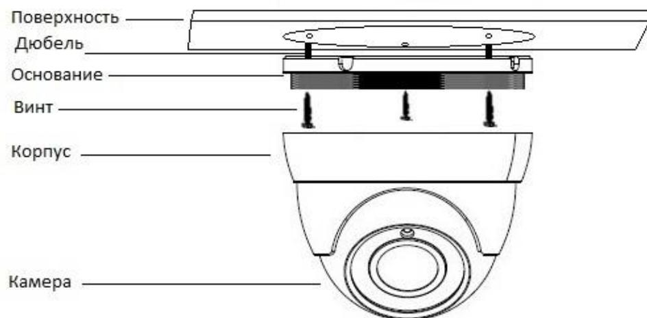
Монтаж камеры может осуществляться как на горизонтальную поверхность, так и на вертикальную. После монтажа на поверхность, настройте ракурс обзора камеры.
