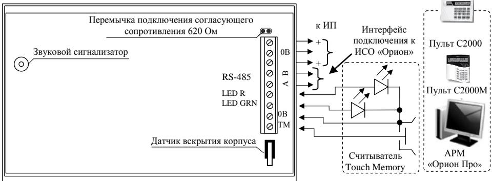
ИП – основной и резервный (опционально) источники питания постоянного тока с напряжением 10,2...28,4 В
