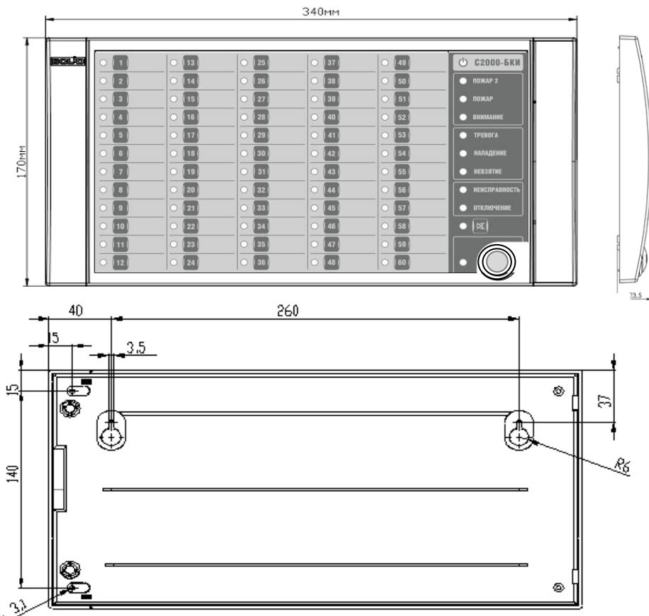
**Рисунок 1.** Внешний вид, габаритные и установочные размеры блока
