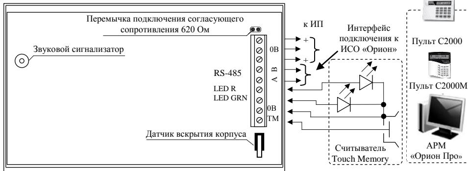
ИП – основной и резервный (оционально) источники питания постоянного тока с напряжением 10,2...28,4 В
