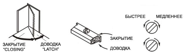
Углы «Закрытие» и «Доводка» регулируются двумя независимыми клапанами. Сперва настраивается скорость «Закрытие» и только потом скорость «Доводка». Регулировка скорости выполняется в соответствии с рисунком выше.
