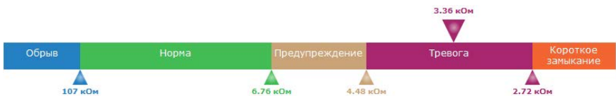
Рисунок 21. Шкала порогов пожарного шлейфа
