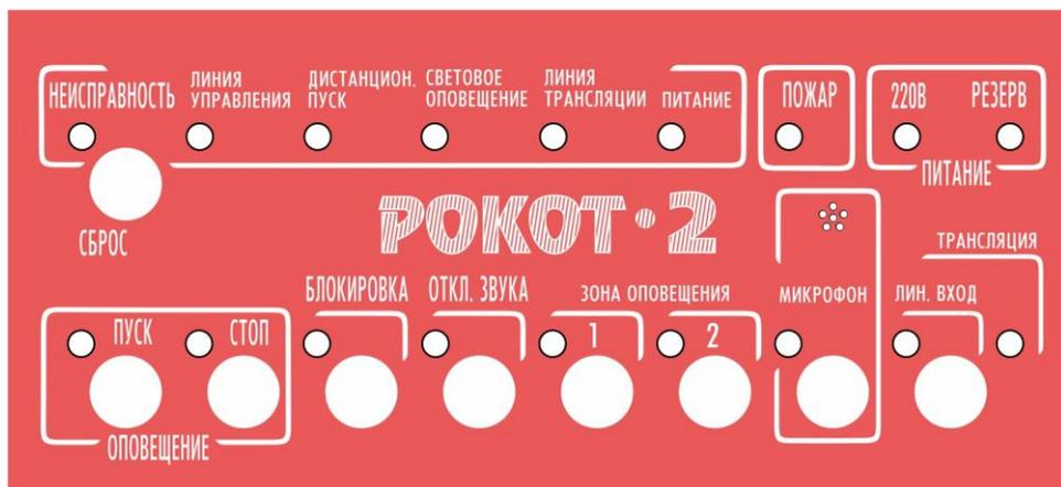
Рис.1 Внешний вид панели индикации и управления прибора
