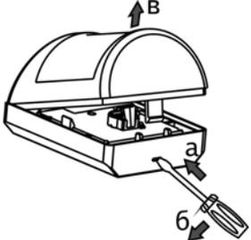
**2** Отогнуть зацепы на основании. Снять плату
