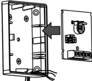
**7** Закрепить подведенные провода в клеммах извещателя.
